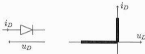
FIGURE 9 – Schéma et caractéristique d'une diode supposée idéale : le graphique représente le courant i_D traversant la diode en fonction de la tension u_D à ses bornes.
