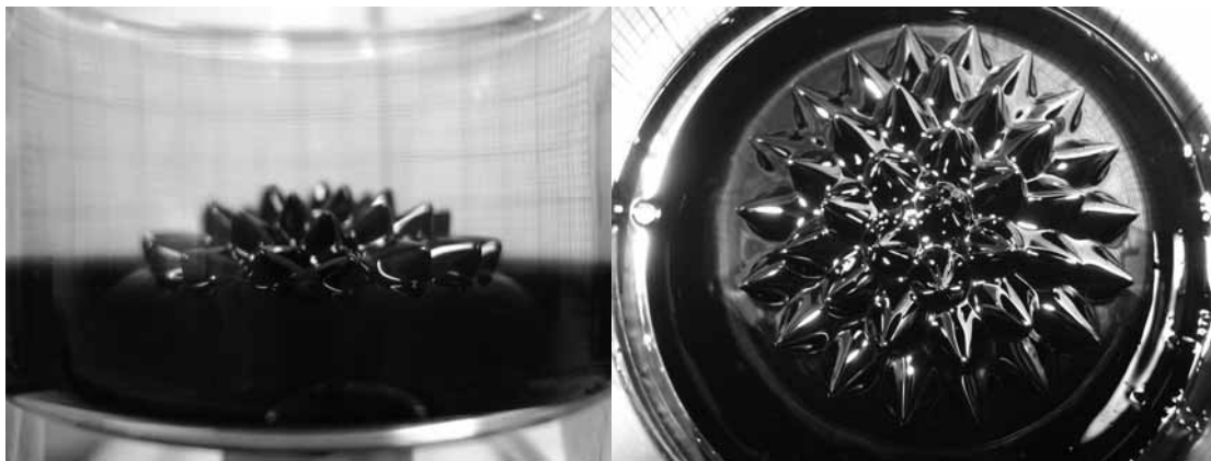
Figure 6 : Instabilité magnéto-hydrostatique d'un ferrofluide générée par un aimant.
