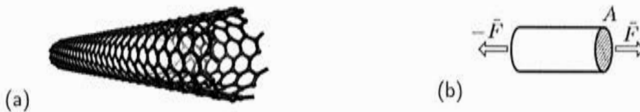
FIGURE 2 – (a) Structure d'un nanotube de carbone. (b) Traction longitudinale sur un cylindre de section A .
