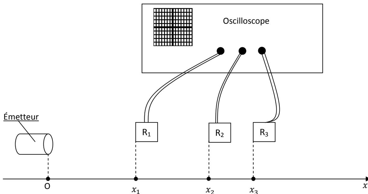
On repère les positions des 3 récepteurs par rapport à l'émetteur à l'aide des abscisses  $x_1, x_2, x_3$  des projections des 3 récepteurs sur un axe  $(Ox)$  ; l'émetteur se projette à l'origine  $O$  de l'axe  $(Ox)$ .
