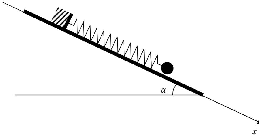
Sur un plan incliné, une masse  $m$  est fixée à l'extrémité d'un ressort, lui-même fixé par son autre extrémité à un mur fixe. Le plan incliné est équipé d'un banc à coussins d'air, de sorte que les frottements peuvent être négligés.
