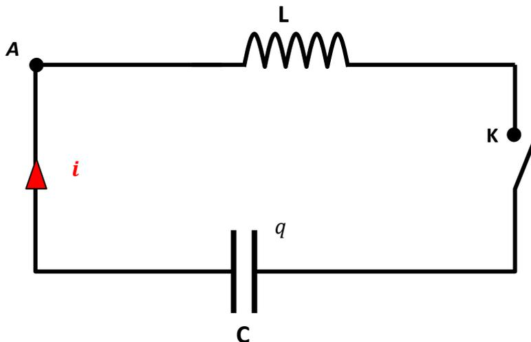
La bobine est idéale : elle a une inductance  $L$  et sa résistance est nulle. On note  $C$  la capacité du condensateur. Le condensateur a été préalablement chargé et à l'instant  $t = 0$  on ferme l'interrupteur  $K$ . On étudie les échanges d'énergie entre le condensateur et la bobine.  $q$  désigne la charge de l'armature du condensateur reliée à l'interrupteur  $K$ .
