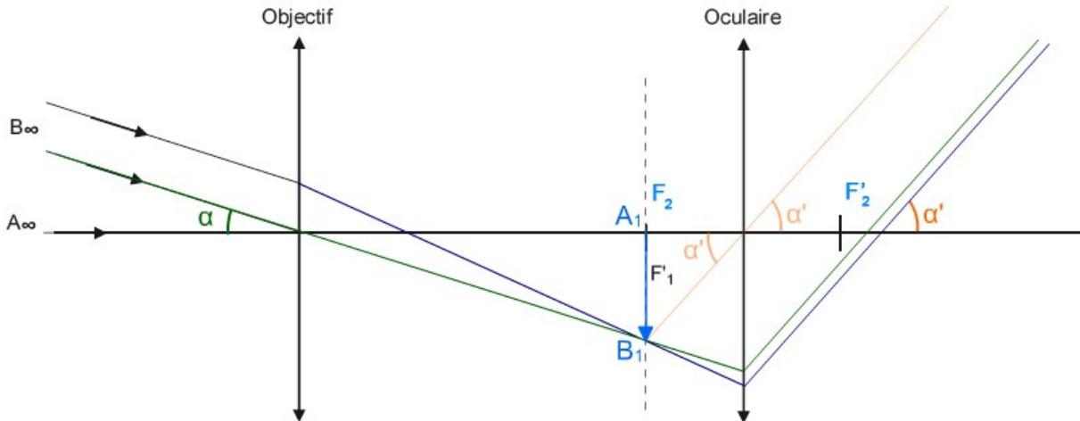
Q3 - L'image  $B_1$  de  $B_\infty$  se trouve dans le plan focal de l'objectif. On la trouve en prolongeant le rayon issu de  $B_\infty$  passant par le centre optique de cet objectif (en vert).  $A_1$  se trouve sur l'axe optique, comme  $A_\infty$ .
