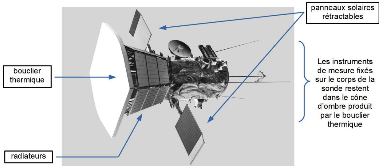
figure 1 - Sonde *PSP* (*Parker Solar Probe*) Source : *blogs.nasa.gov*
