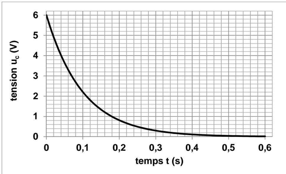
**Figure 6 : Décharge du condensateur *au niveau du sol***
