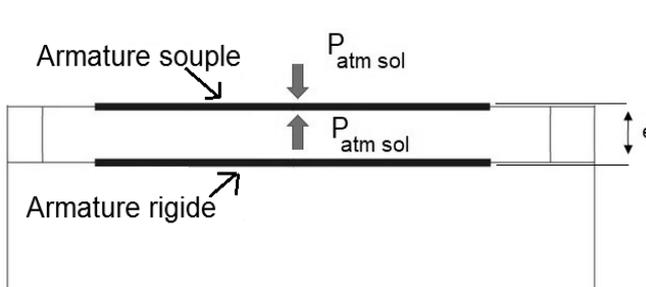
**Figure 7 : Condensateur au niveau du sol**
