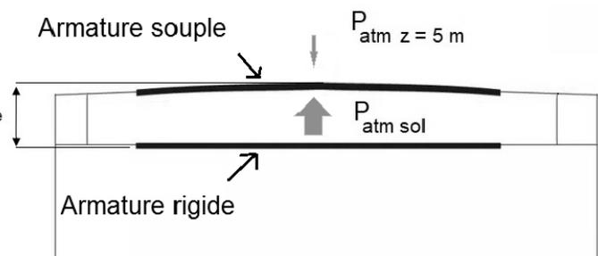
**Figure 8 : Condensateur à 5,0 m d'altitude**
