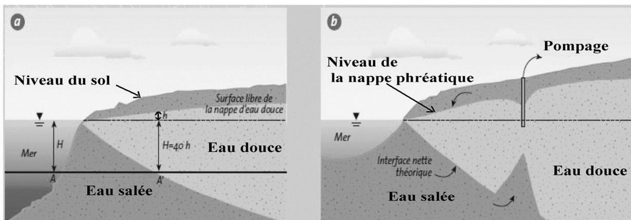
**Figure 1 : Lors de l'exploitation d'un forage dans une nappe phréatique côtière, un cône de rabattement se forme au niveau de la surface de la nappe, qui modifie l'interface entre l'eau douce et l'eau salée. Source : d'après <https://library.ensh.dz>.**
