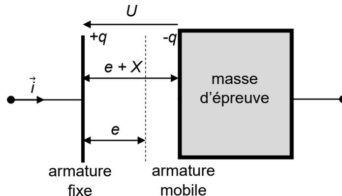
On applique une tension  $U$  entre les armatures du condensateur plan. En l'absence de force non-gravitationnelle, la distance entre les deux armatures (fixe et mobile) est notée  $e$ . En présence d'une force non-gravitationnelle, l'armature mobile subit un déplacement  $X$  (compté positivement) dans la direction définie par le vecteur unitaire  $\vec{i}$  indiqué sur le schéma ci-dessus.
