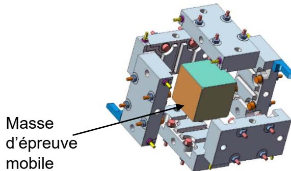
Schéma de la cage électrostatique maintenant la masse d'épreuve en suspension
