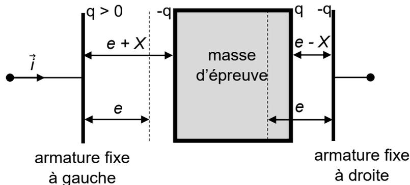
**C.4.** Établir la relation existant entre le champ électrique  $\vec{E}_d$  créé par l'armature fixe de droite et le champ électrique  $\vec{E}_g$  créé par l'armature fixe de gauche.
