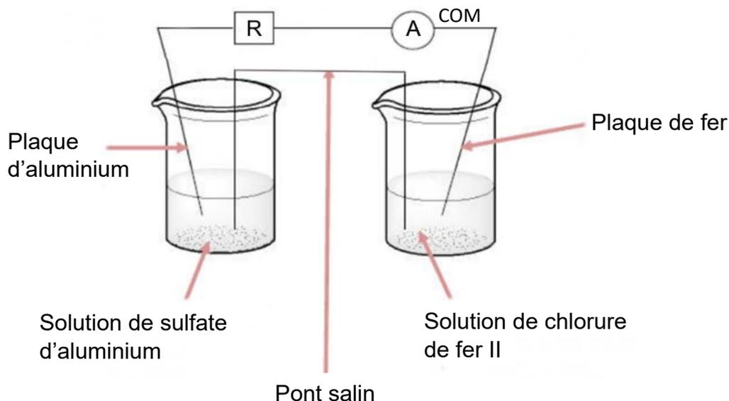
Dans un bécher, on verse un volume  $V_1 = 50,0 \text{ mL}$  de solution aqueuse de chlorure de fer II ( $\text{Fe}^{2+}(\text{aq}) + 2 \text{Cl}^{-}(\text{aq})$ ) de concentration apportée en quantité de matière  $C_1 = 1,0 \times 10^{-1} \text{ mol}\cdot\text{L}^{-1}$ , puis on y plonge une plaque de fer.
