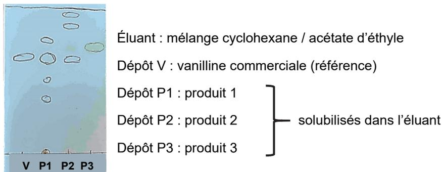
Figure 3. Chromatogramme obtenu expérimentalement
