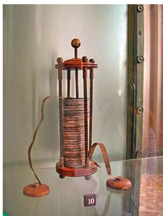
Figure 1. Photographie d'une pile Volta
