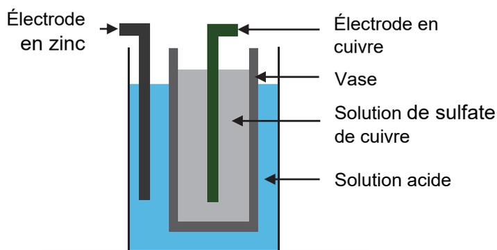
Figure 6. Sch ma en coupe d'une pile Daniell
