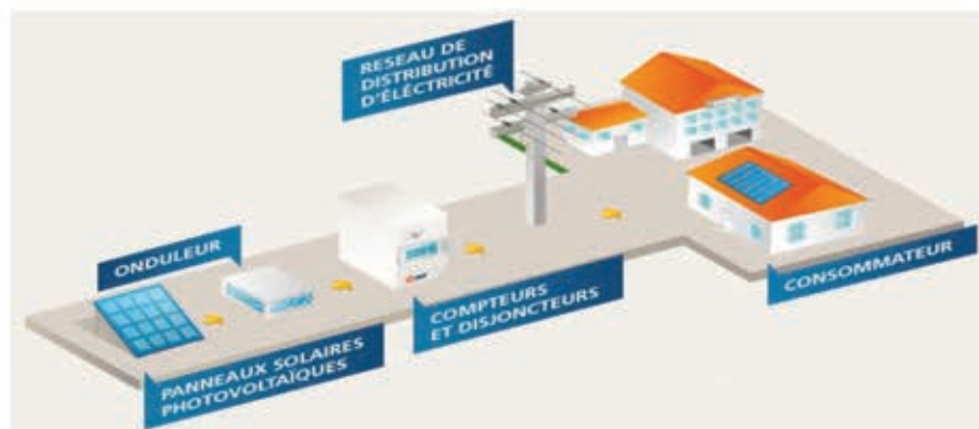
Figure 8. – Installation photovoltaïque raccordée au réseau électrique
