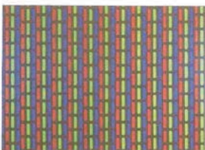
Doc 2 Luminophores d’un écran de télévision.
