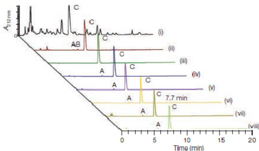
(i) Brut réactionnel ; (ii) Brut réactionnel après passage sur une colonne de silice (chromatographie sur colonne de silice) ; (iii) Produit recristallisé ; (iv) à (viii) Différents échantillons commerciaux d'artémisinine obtenue à partir de l'extraction de plantes.
