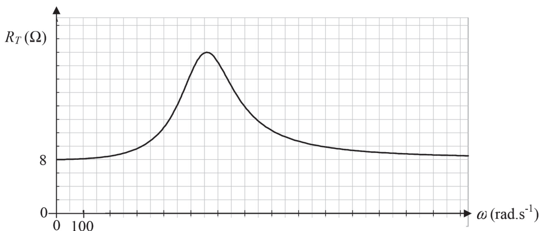
Figure 4 : courbe représentant R_T en fonction de \omega
