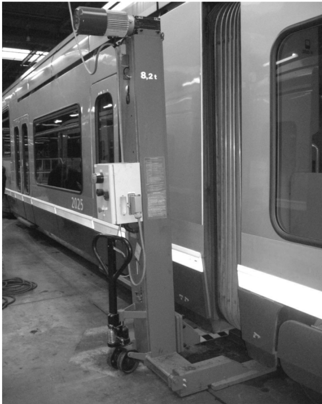
Photo 3 : Mise en place d'une colonne
