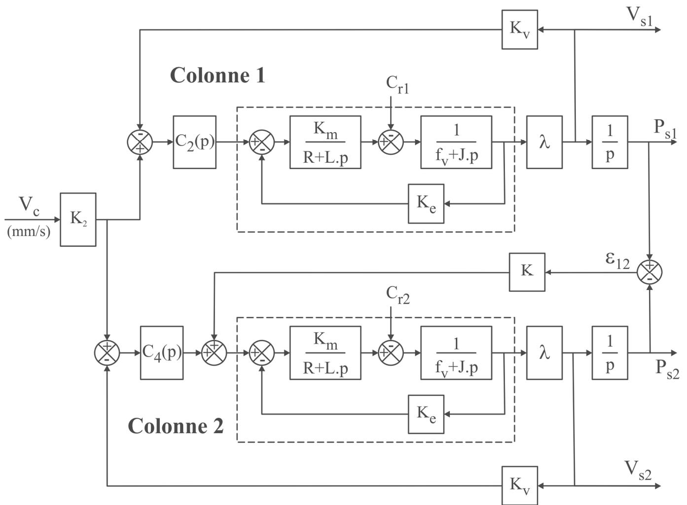
Figure 14 : Commande asservie, schéma SIMPLIFIÉ (Pour information)
