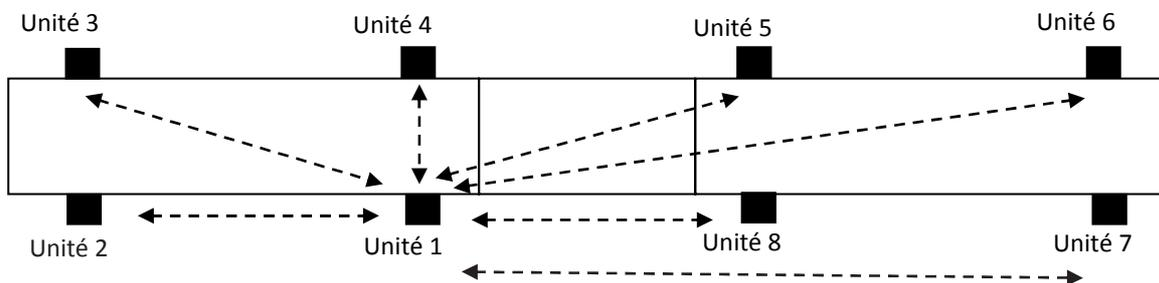
La première méthode nécessite l'utilisation de modèles de commande plus complexes que la deuxième. La deuxième méthode autorise un écart plus important entre deux colonnes, et permet éventuellement de l'individualiser. C'est cette deuxième méthode qui a été retenue par le fabricant.
