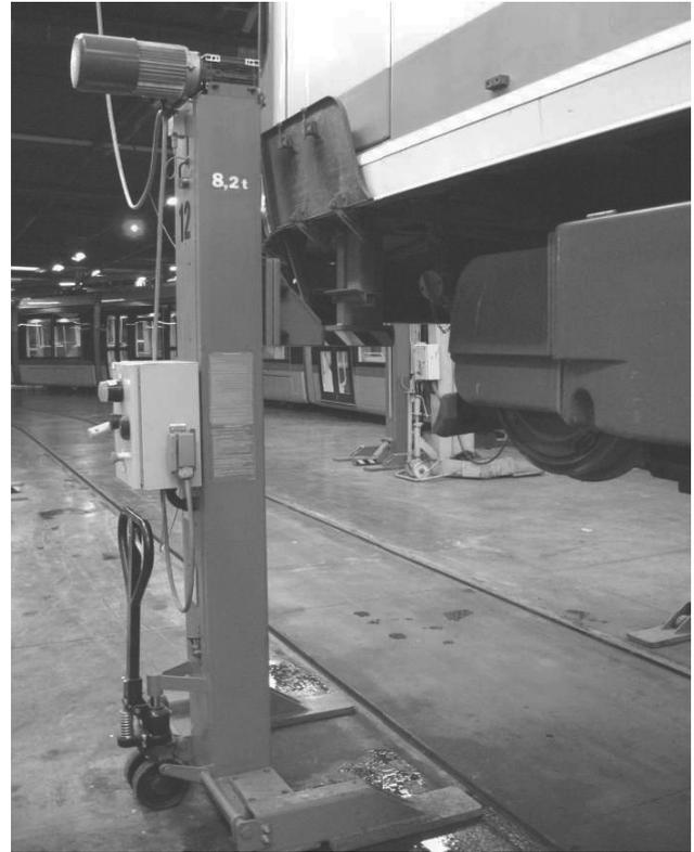
**Photo 4 : Colonne d'extrémité en phase de levage**
