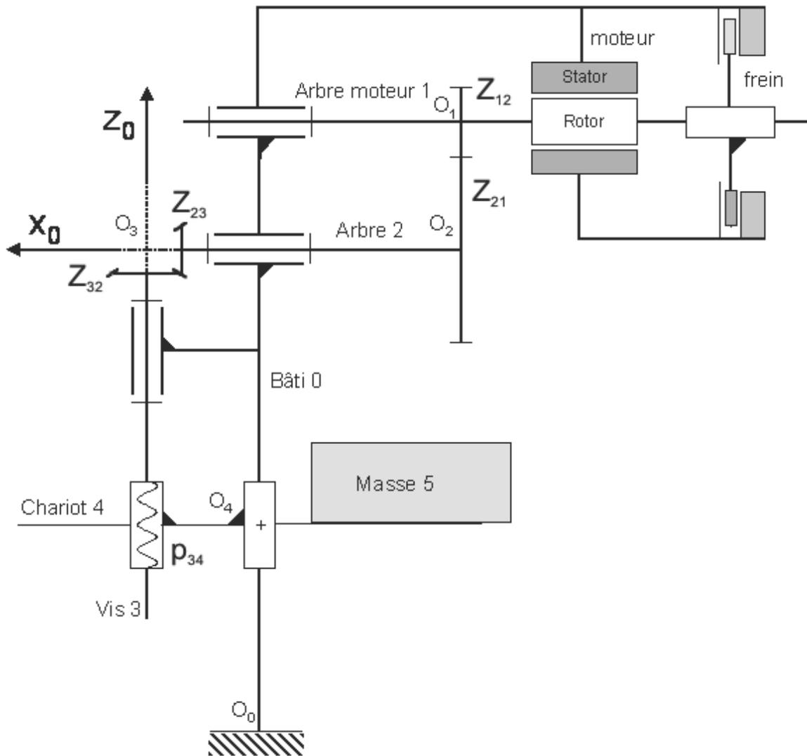
**Actions exercées par le moteur :** Actions exercées par le stator sur le rotor modélisées par le couple  $C_m$
