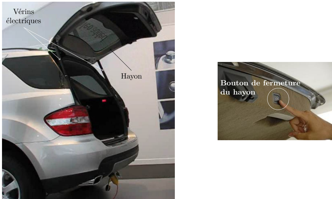
Figure 2 Description d'un hayon
