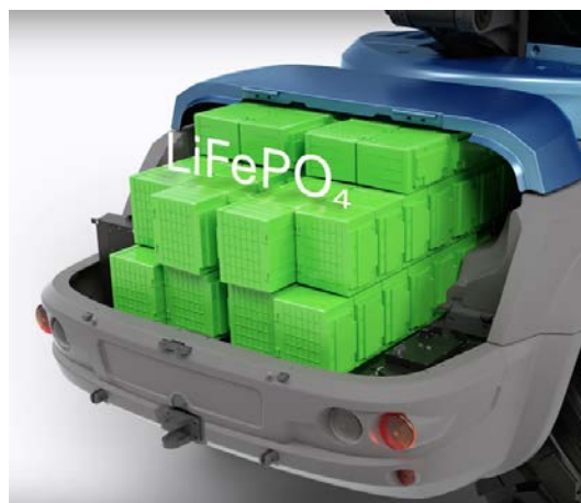
Figure 14 – intégration de la batterie
