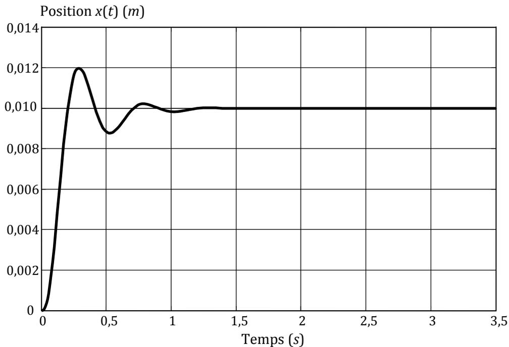
**Figure R7 : Position du chariot 1 pour un échelon de position de 0,01 m avec le correcteur  $C_2(p)$**
