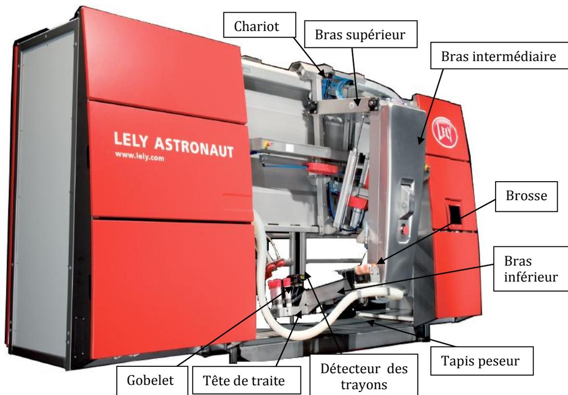
*Figure 1 : Robot de traite Astronaut A3*
