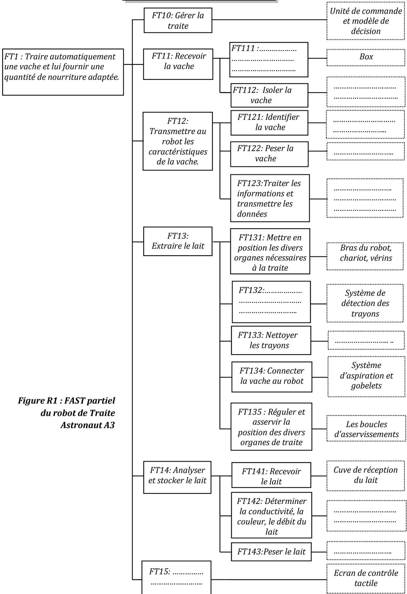
**Figure R1 : FAST partiel du robot de Traite Astronaut A3**
