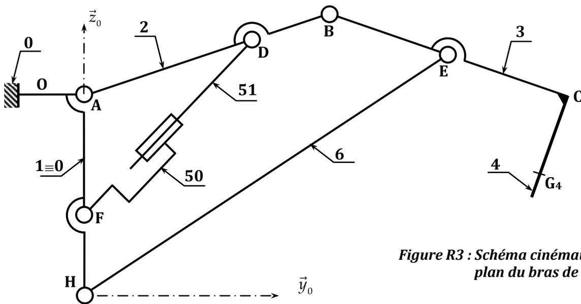
Figure R3 : Schéma cinématique plan du bras de robot
