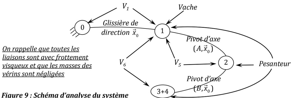
Les lois de mouvement étant connues on désire dimensionner les vérins  $V_1$ ,  $V_5$  et  $V_6$  permettant de réaliser ces lois de mouvement.
