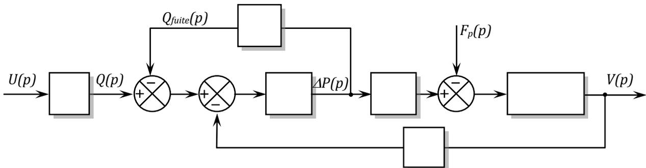
**Figure 11 : Schéma-blocs de l’ensemble « vérin + charge »**
