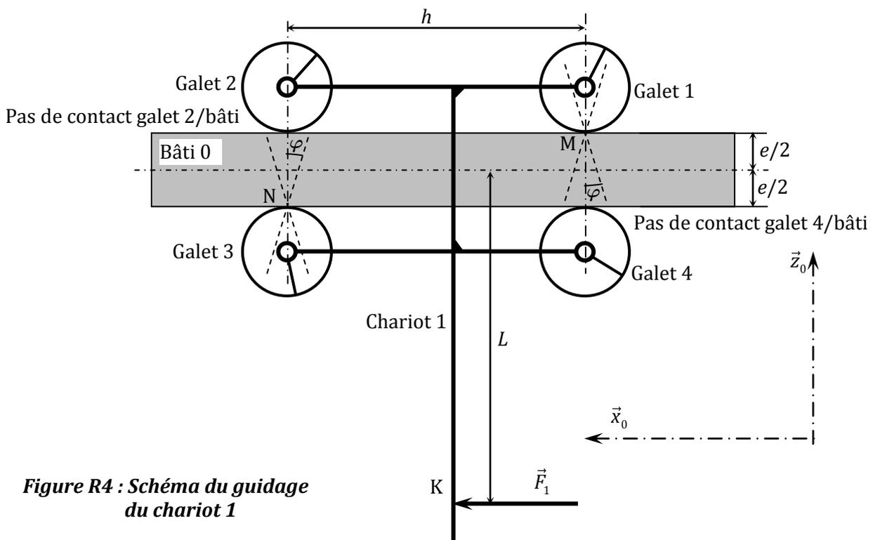
Figure R4 : Schéma du guidage du chariot 1
