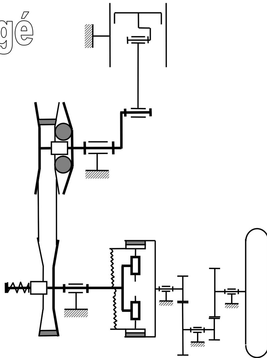
Figure 3 : Phase de non glissement dans l'embrayage et variation des rayons des poulies du variateur à courroie
