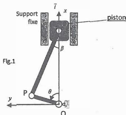
Dans la suite, on considère que le piston est soumis sur sa face supérieure à une force supplémentaire  $\vec{F} = -F(t)\vec{i}$ , où  $F(t) = F_0 \sin \theta(t)$  et  $F_0$  est une constante positive donnée.
