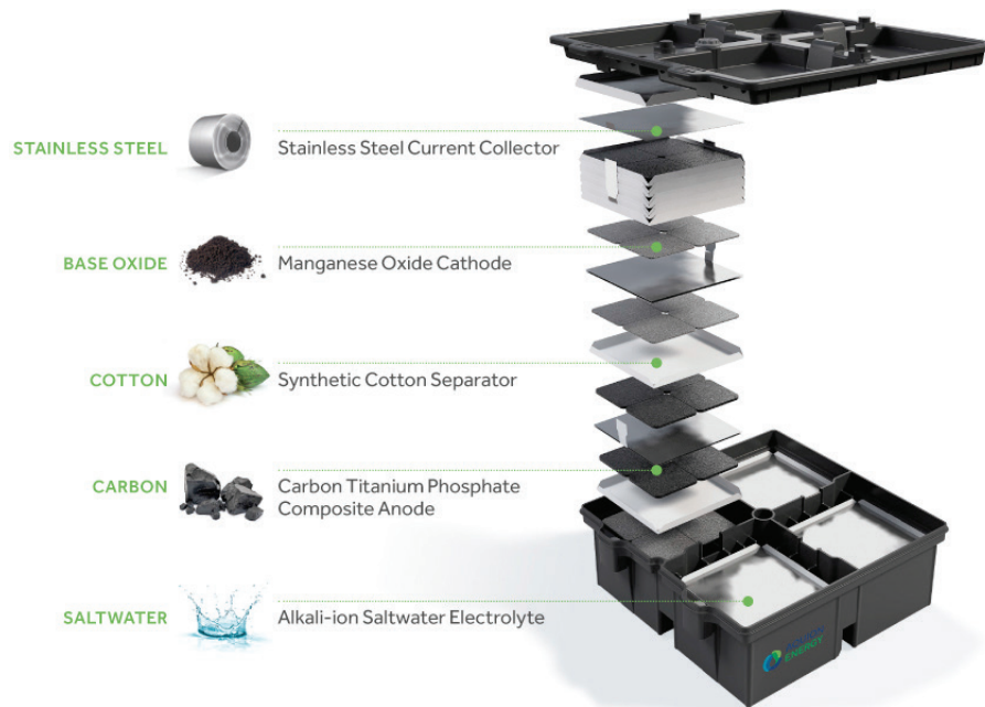
FIGURE 12 – Composition de la batterie Aquion, de haut en bas : collecteur de courant en acier, cathode en oxyde de manganèse, séparateur en coton synthétique, anode composite carbone/titane/phosphate, électrolyte ions alcalins/eau salée.
