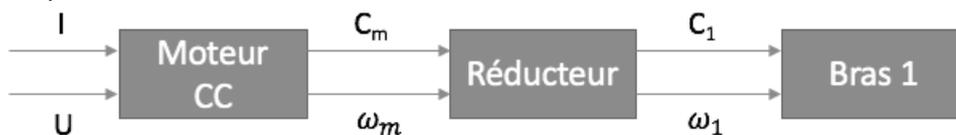
Fig.4 : chaîne d'énergie
