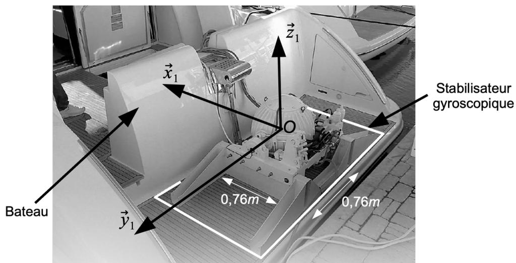
Figure 2 : Stabilisateur gyroscopique monté sur un bateau
