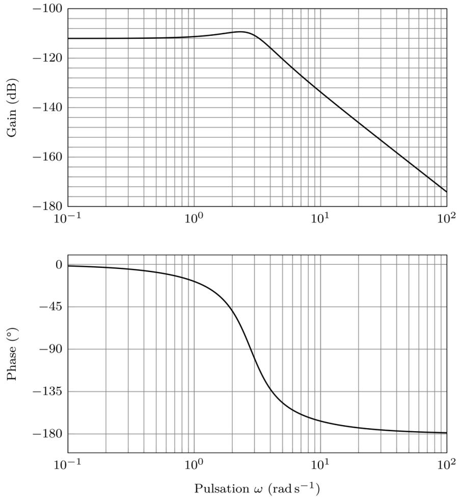
Figure 10 : Diagrammes de Bode de la fonction de transfert  $H_r(p)$ .
