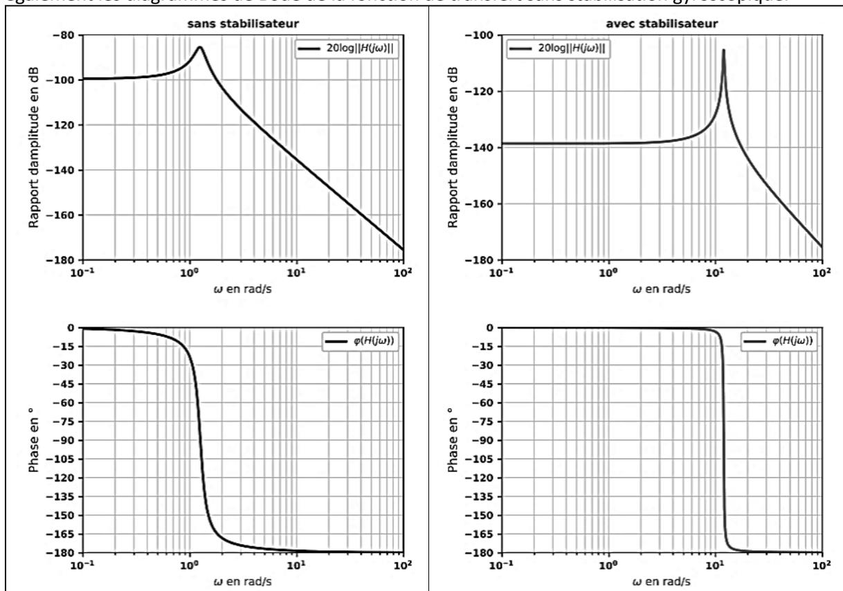
Figure 8 : Diagrammes de Bode du système sans stabilisateur (gauche) et avec stabilisateur gyroscopique (droite). Le rapport d'amplitude  $|H(j\omega)|$  est en  $\text{rad} \cdot \text{N}^{-1} \cdot \text{m}^{-1}$ .
