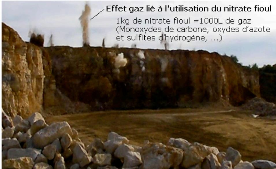
Les tirs de mines ne doivent pas être à l'origine de vibrations susceptibles d'engendrer dans les constructions avoisinantes des vitesses pondérées supérieures à 10 mm/s mesurées. Les fréquences ressenties durant le tir sont aussi importantes. En effet, la fréquence de résonance des bâtiments se situe entre 8 Hz et 11 Hz. Il faut donc éviter cette plage de fréquences pour empêcher les constructions d'entrer en résonance et prévenir d'éventuels dégâts.
