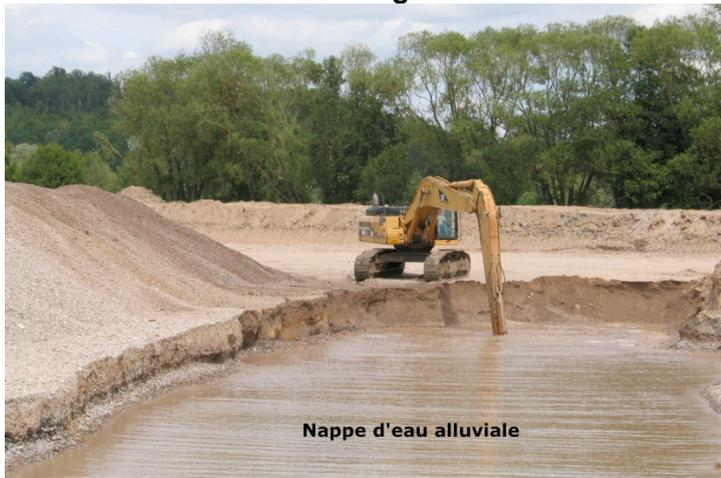
L'extraction des granulats alluvionnaires se fait à la pelle hydraulique pour les gisements de faible épaisseur. Au sein de ces alluvions se trouve une nappe alluviale qui peut par ailleurs alimenter la population en eau.
