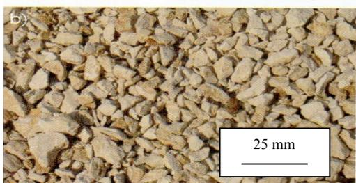
Les granulats sont des morceaux de roches d'une taille comprise entre 0 et 125 mm, destinés à réaliser des ouvrages de travaux publics, de génie civil et de bâtiment.
