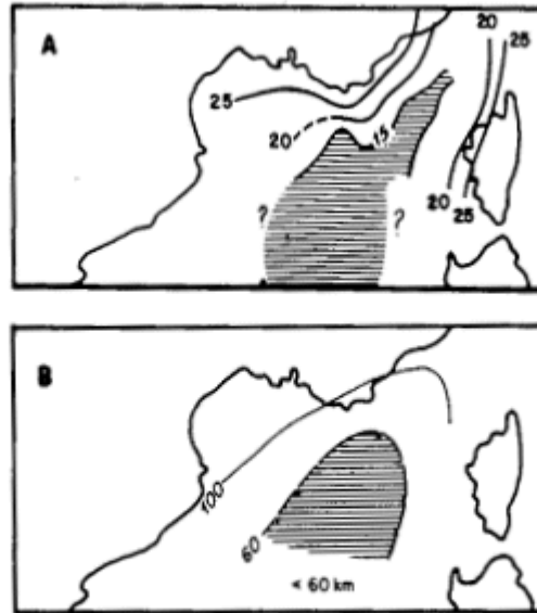
Profondeur (km) du Moho (A) et de la limite asthénosphère-lithosphère (B) dans le bassin nord-occidental de la Méditerranée. En A, la surface ombrée correspond à la croûte océanique (d'après SOURIAU-THEVENARD, 1978 et LE DOUARAN et al., 1984).
