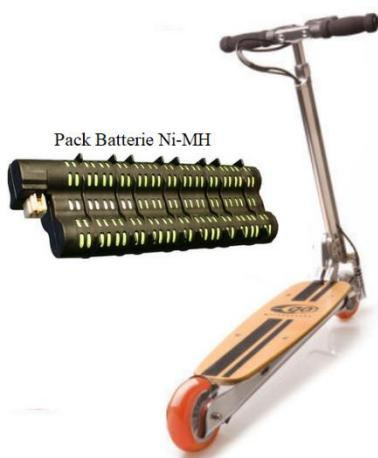
La deuxième génération de trottinettes électriques utilisait des batterie Nickel - Métal Hydure (Ni-MH).
