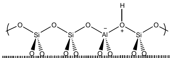
Figure 8 : Représentation schématique de la surface de la zéolithe.
