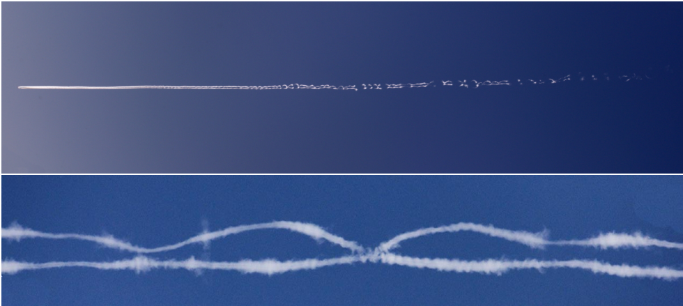
Figure 8: Tourbillons de sillage derri re un avion. L'image du bas est un zoom de celle du haut.
